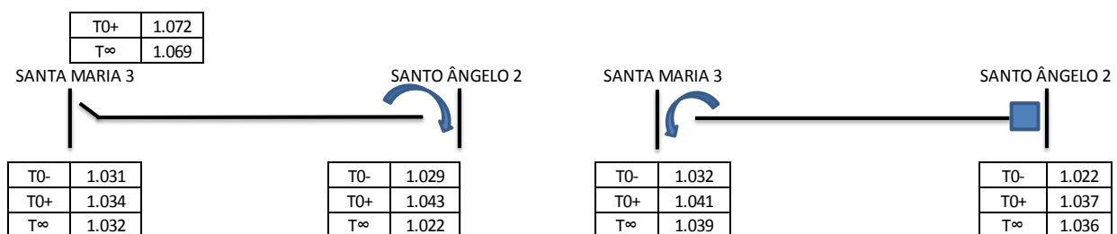
Figura 5-25 Energização da LT 230kV Santa Maria 3 – Santo Ângelo 2 pelo terminal de Santo Ângelo 2.
